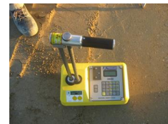
Ensaio do aterro com Gama densímetro
